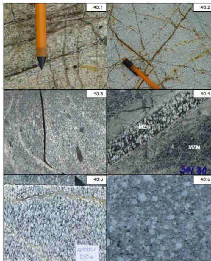
FIGURA 2- 7. Ferrobamba. Fotos: 40.1. Monzonita Biotítica (MZB) con libros de biotita y venillas delgadas de cuarzo sin mineral, 40.2. Monzonita Biotítica Fina 1 (MBF1) con libros de biotita y venillas de cuarzo con óxidos, 40.3. Monzonita Biotítica Fina 2 (MBF2) con esporádicos libros de biotita y matriz negruzca, 40.4. Monzonita Máfica (MZM) cortada por Monzonita Hornbléndica (MZH), 40.5. Monzonita Hornbléndica, 40.6. Monzonita Cuarzosa.
