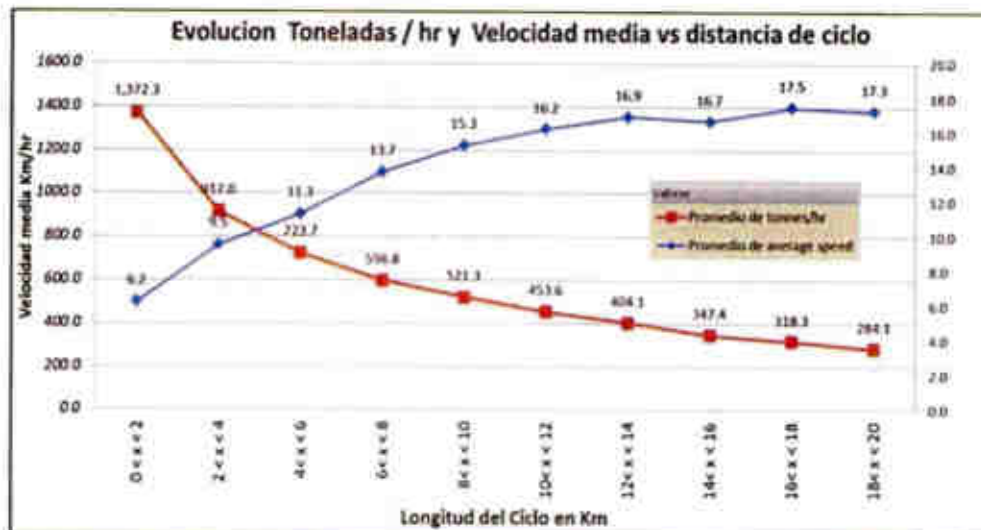
FIGURA 5-13. Evolución del tonelaje vs velocidad media y el ciclo. Fuente: Minera Las Bambas.
