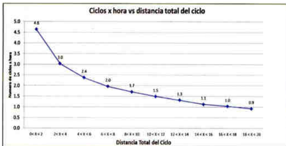
FIGURA 5-11. Ciclos por Hora vs Distancia Total del Ciclo. Fuente: Minera Las Bambas.
