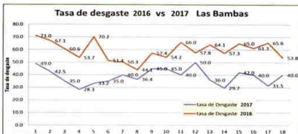
FIGURA 5-5. Tasa de desgaste de los neumáticos (2016 – 2017).
