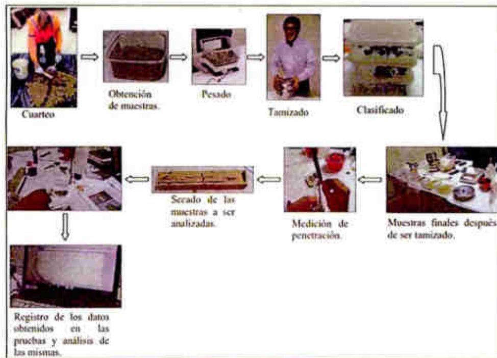
FIGURA 6-3. Prueba de laboratorio – Flujo de procesos.
