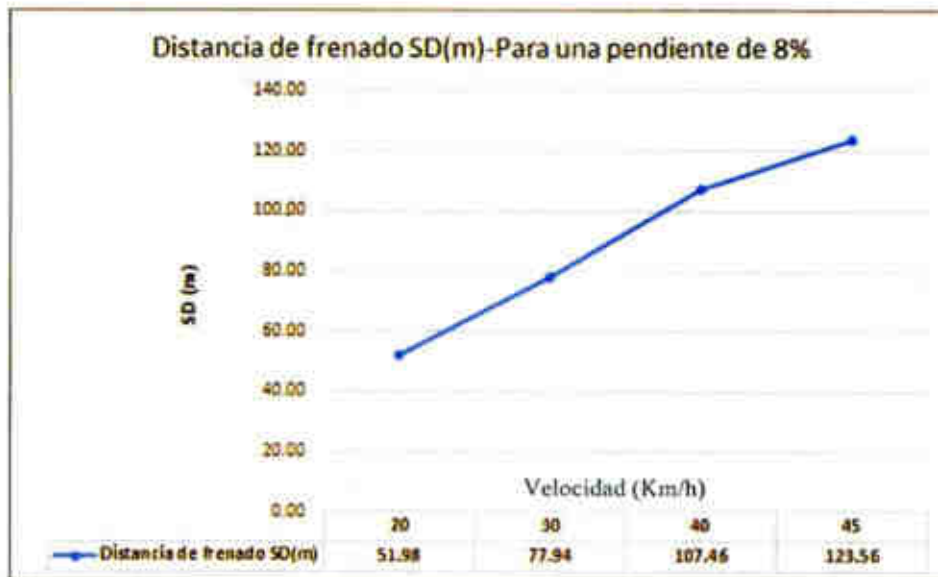
FIGURA 3-8. Distancia de frenado en función a la velocidad para una pendiente de 8% aplicado en las vías de acarreo de Las Bambas.
