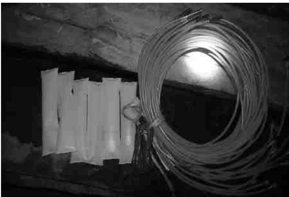
Foto N° 12: accesorios de voladura
