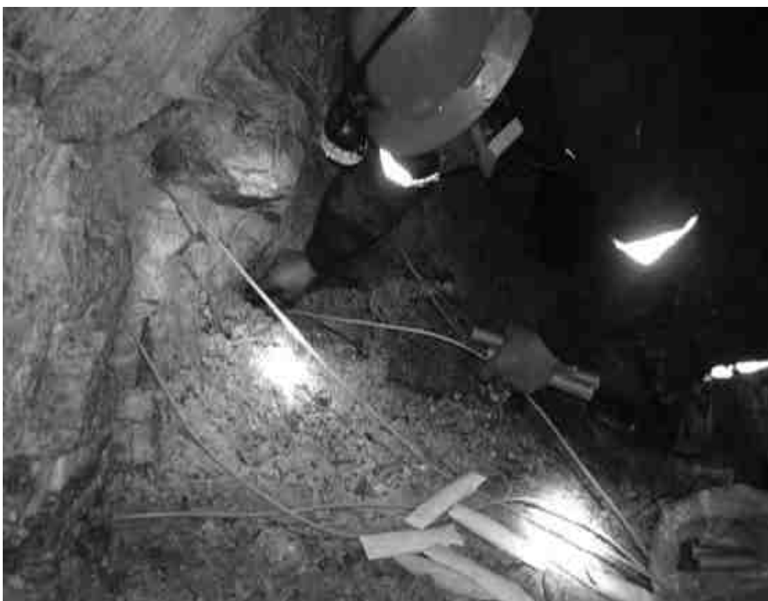
Foto N° 14: carguío en el tajo
