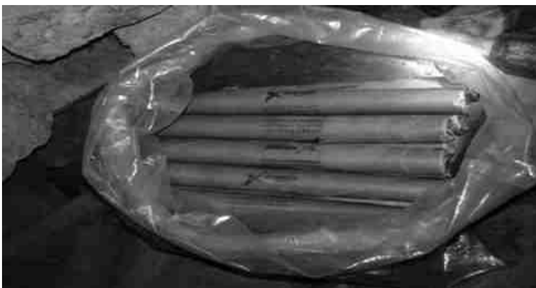
Foto N° 3: Explosivo Semexsa 65% de 7/8pulg x 7pulg
