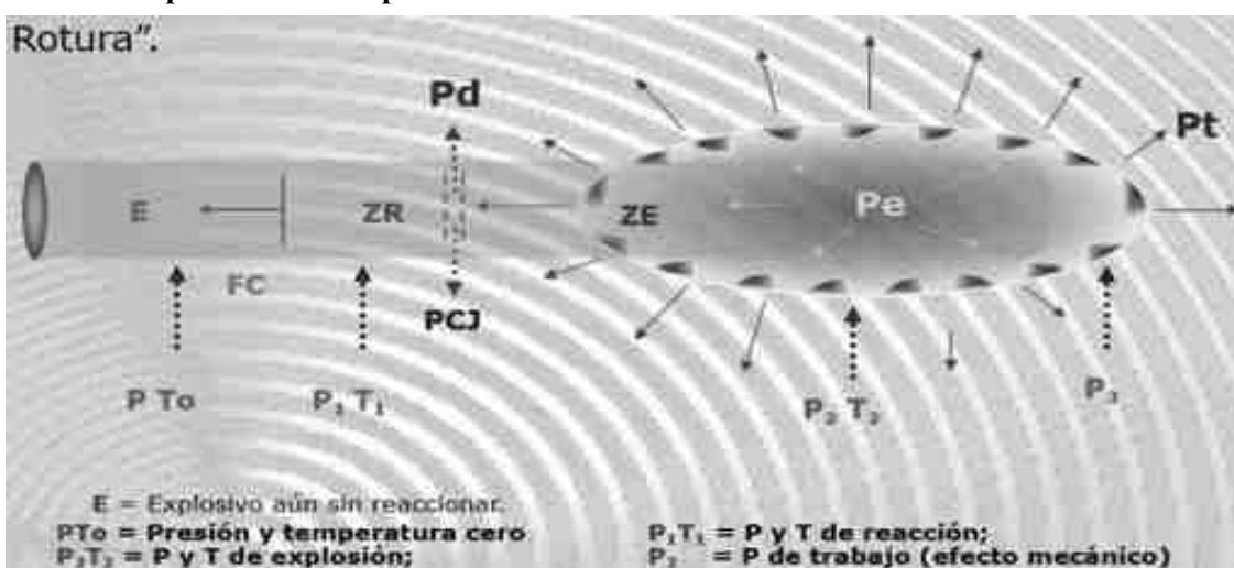
Figura N° 8: Explosión del explosivo generando la mecánica de rotura
