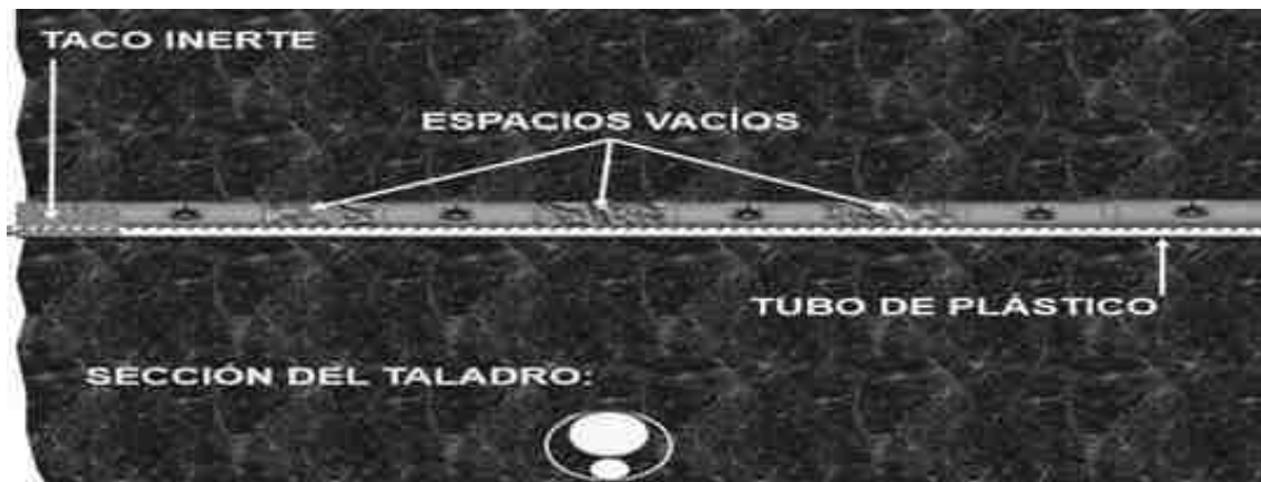
Figura N° 13: Carguío en voladura amortiguadora con tubo plástico
