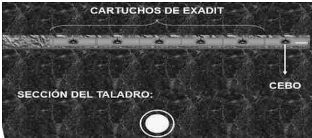
Figura N° 11: carguío en voladura amortiguadora con Exadit
