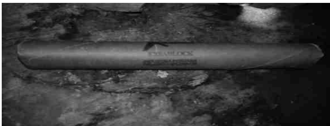
Foto N° 4: Explosivo Exsablock de 7/8pulg x 7pulg
