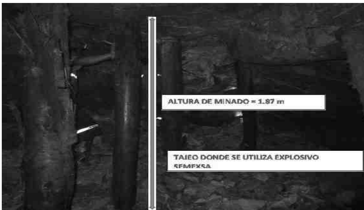
Foto N° 9: Altura de minado utilizando dinamita Semexsa 65%
