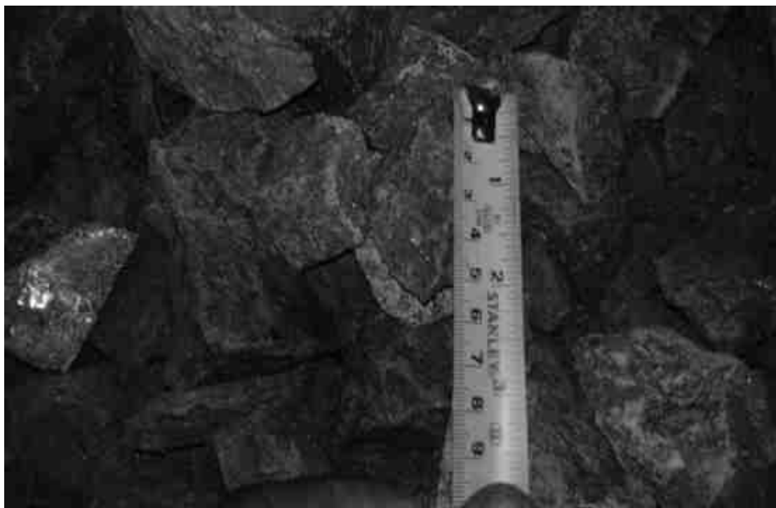
Foto N° 19: granulometría del carguío S+E
