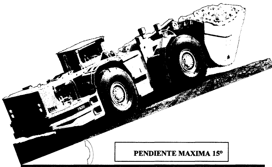
Fig. III-35. La operación en cuesta subida en un pendiente máximo de 15%, donde la altura máxima de la cuchara debe estar 15" del piso.
