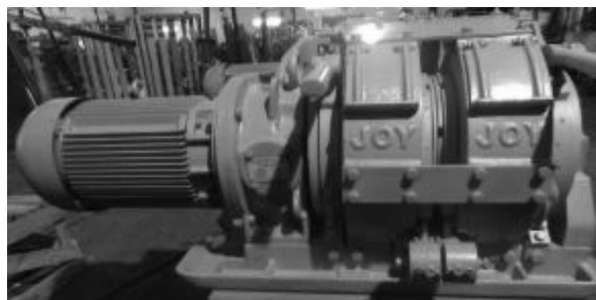
Figura 29: Winche eléctrico de 15 HP de potencia.
