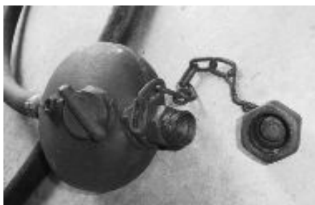
Figura 22: Lubricadora usada en Minera tauro S.A.C.
