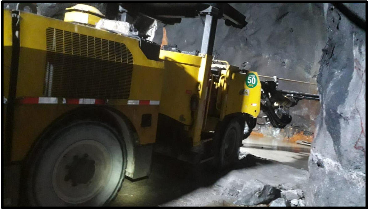
Figura 18 — Equipo perforador jumbo
