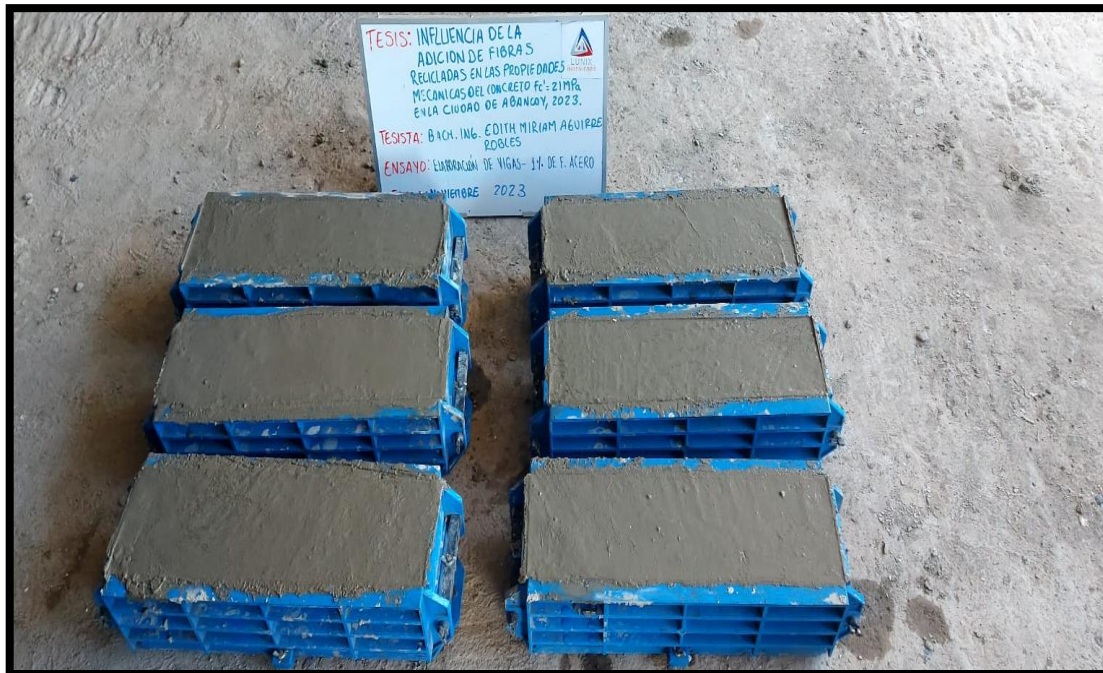
Figura 56 — Elaboración de vigas de concreto
