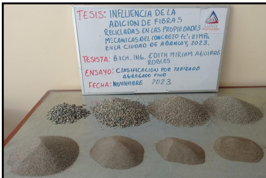
Figura 51 — Análisis granulométrico del agregado fino
