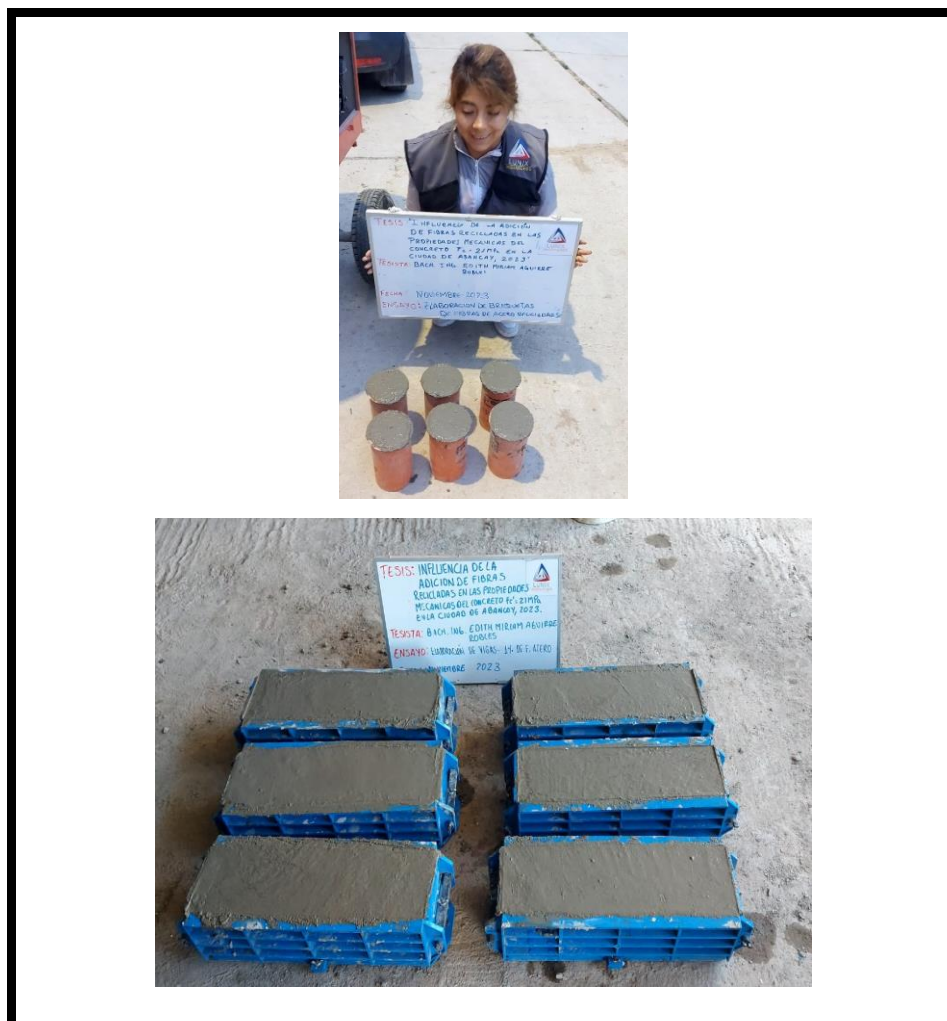
Figura 10 — Elaboración de briquetas y vigas de concreto
