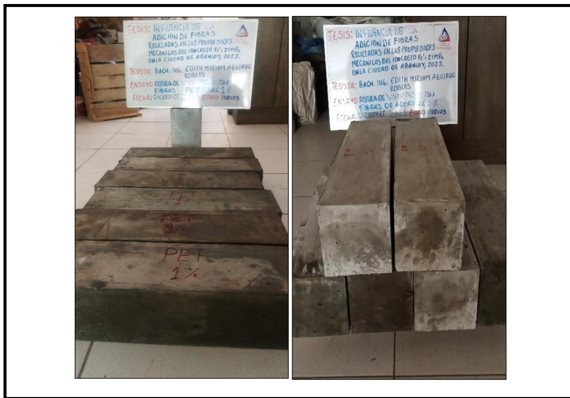
Figura 59 — Vigas de concreto antes del ensayo de resistencia a la flexión con cargas a los tercios del tramo
