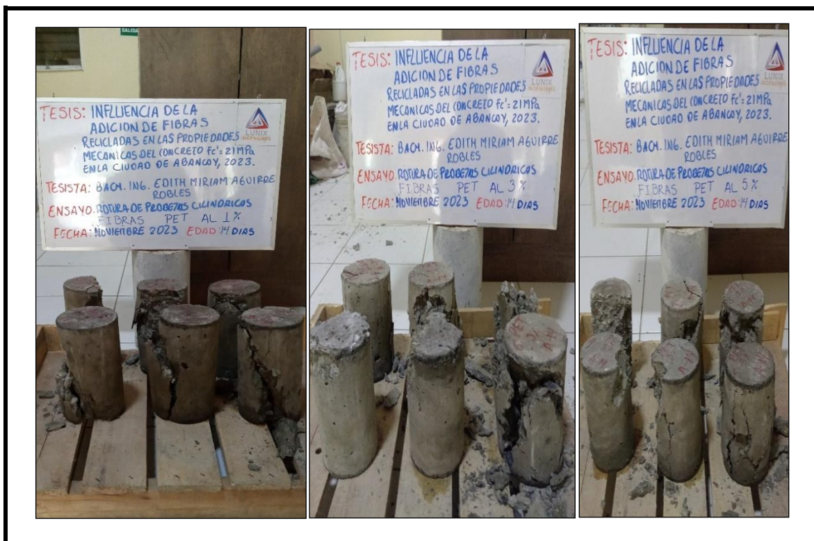
Figura 62 — Especímenes cilíndricos de concreto después de ser sometidos al ensayo de compresión simple
