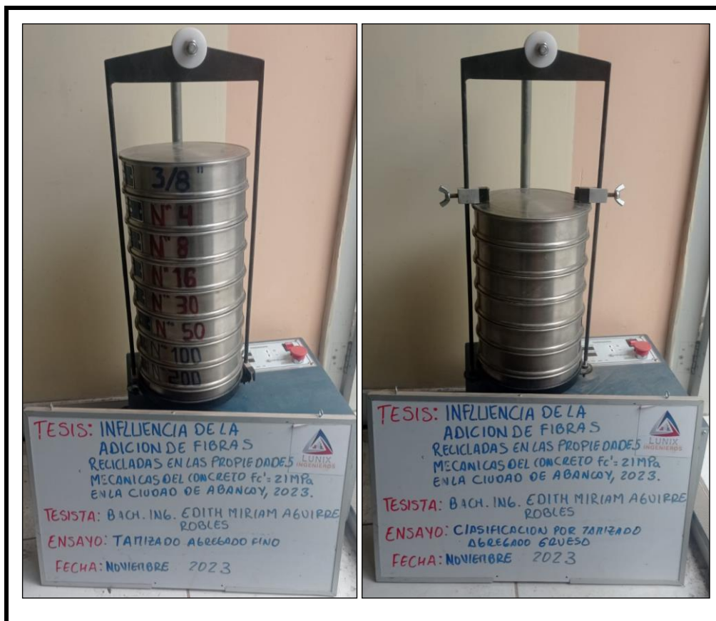
Figura 52 — Proceso de tamizado del agregado fino y grueso
