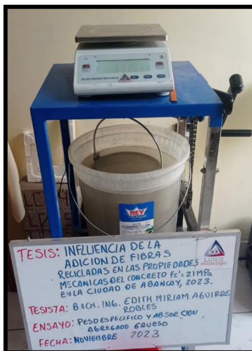
Figura 53 — Peso específico y absorción del agregado grueso
