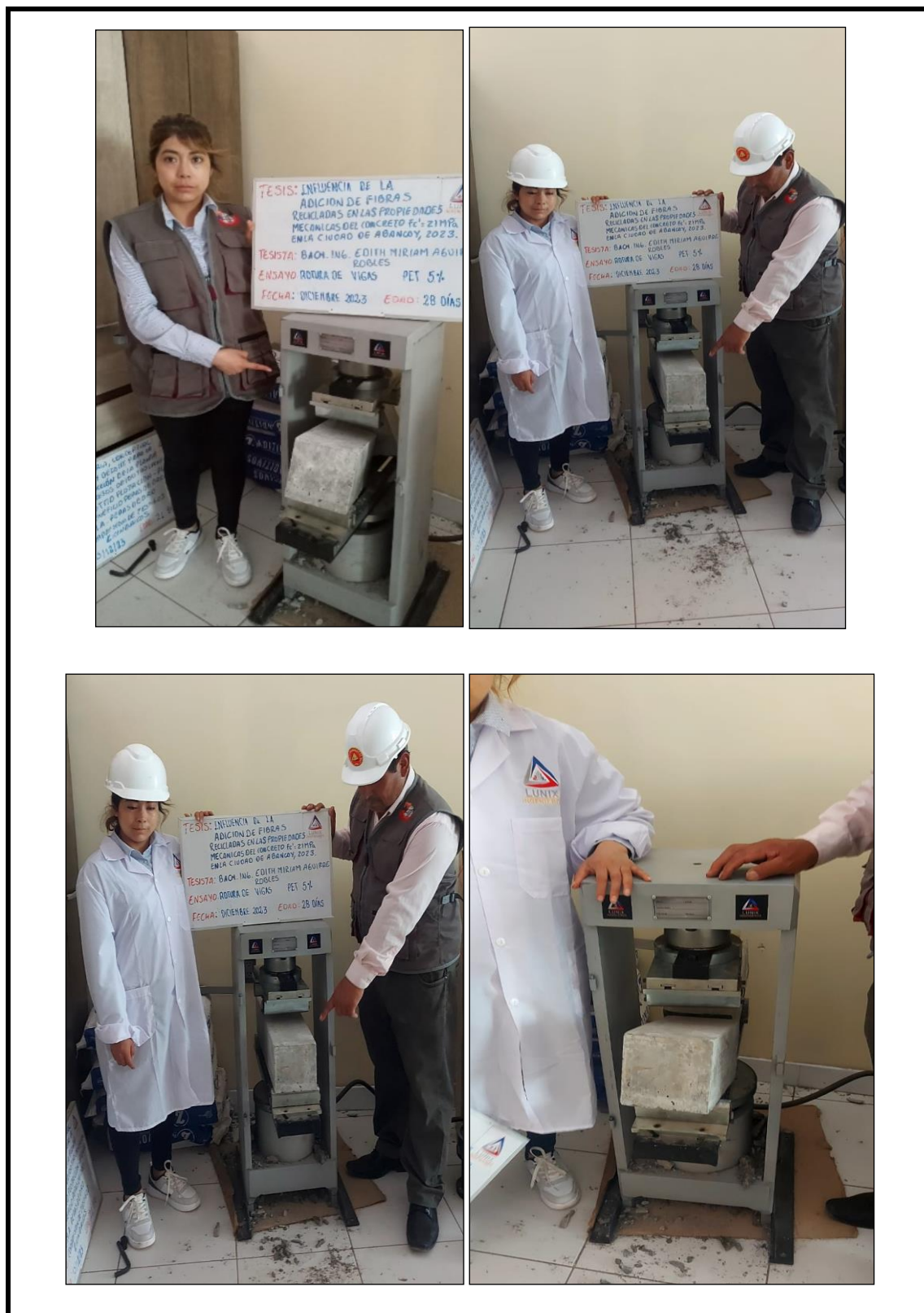
Figura 65 — Ensayo de resistencia a la flexión del concreto en vigas a edades de 7, 14 y 28 días
