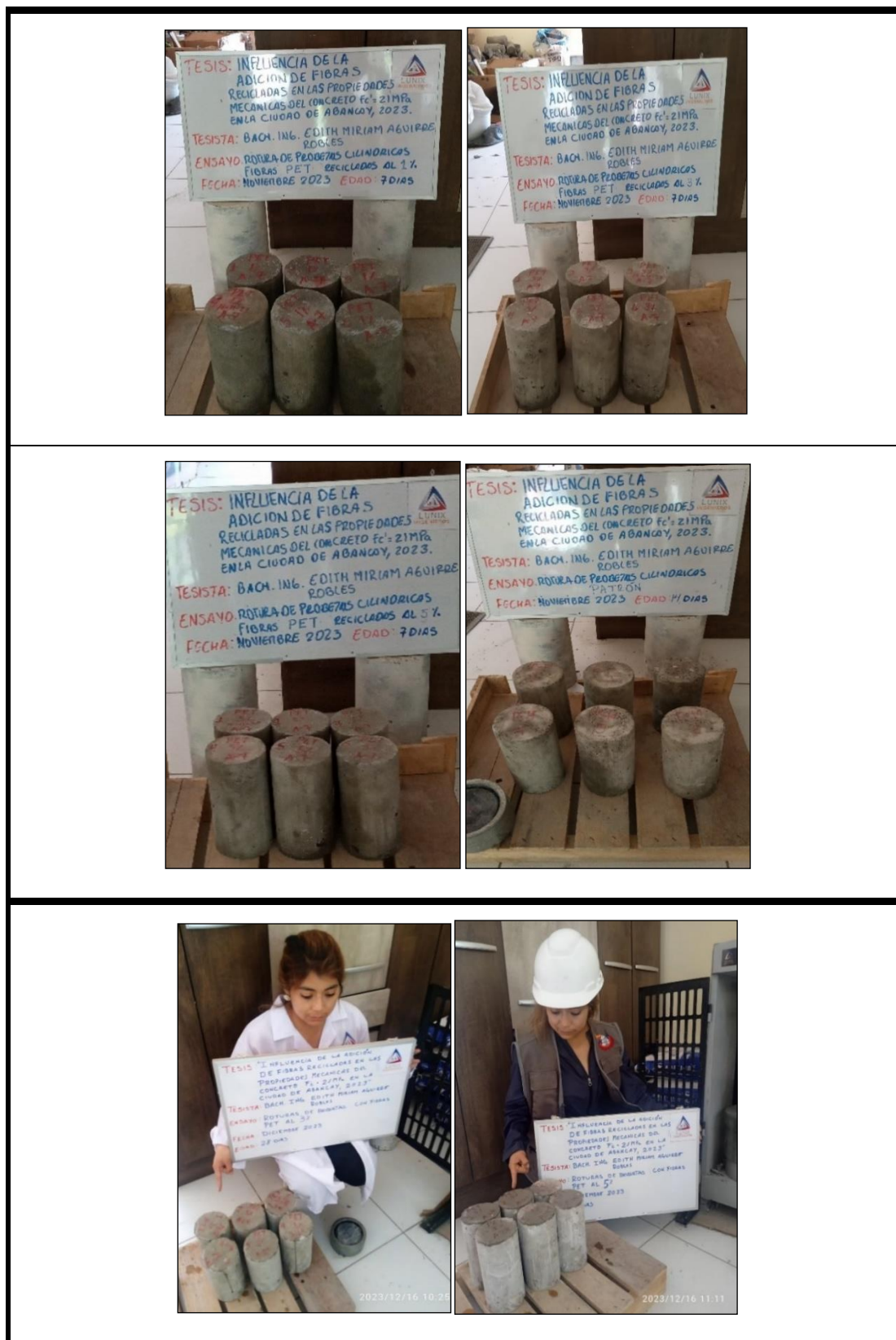
Figura 58 — Especímenes cilíndricos de concreto antes de ser sometidos al ensayo de compresión simple
