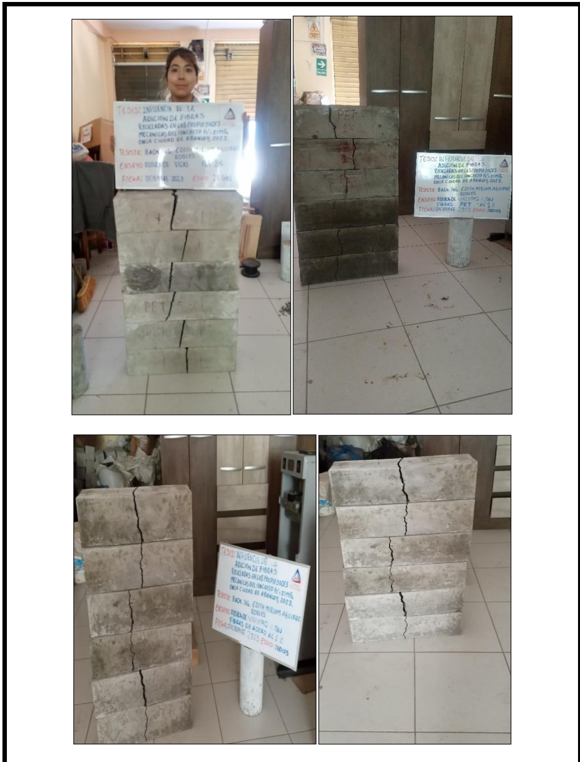
Figura 63 — Vigas de concreto después de ser sometidos al ensayo de flexión con cargas a los tercios del tramo
