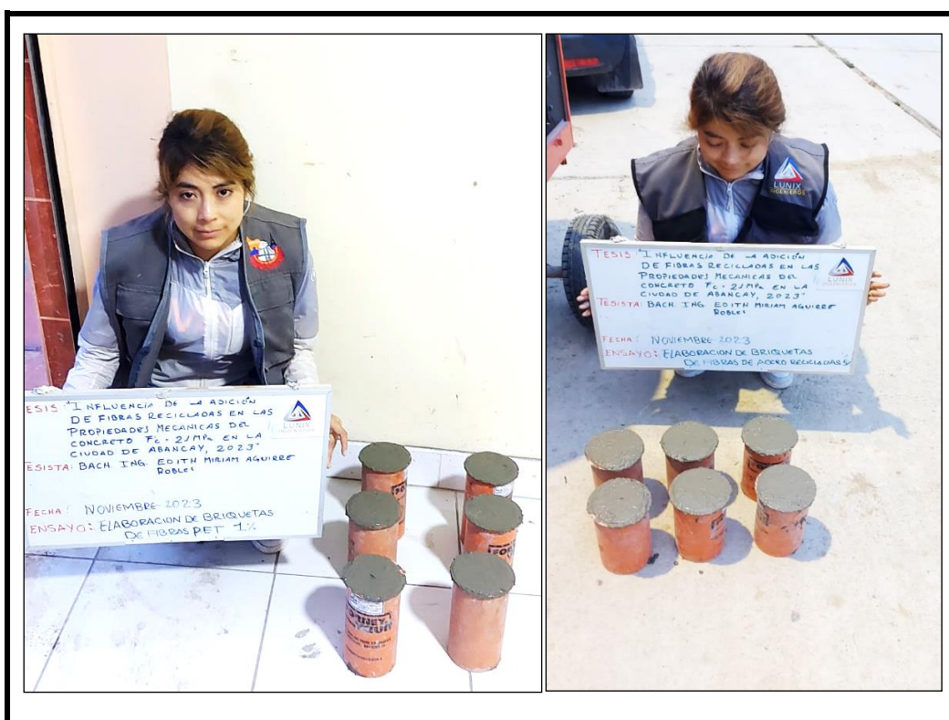
Figura 55 — Elaboración de probetas cilíndricas de concreto
