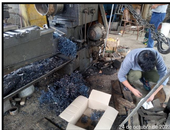
Figura 7 — Reciclaje de fibra de acero
