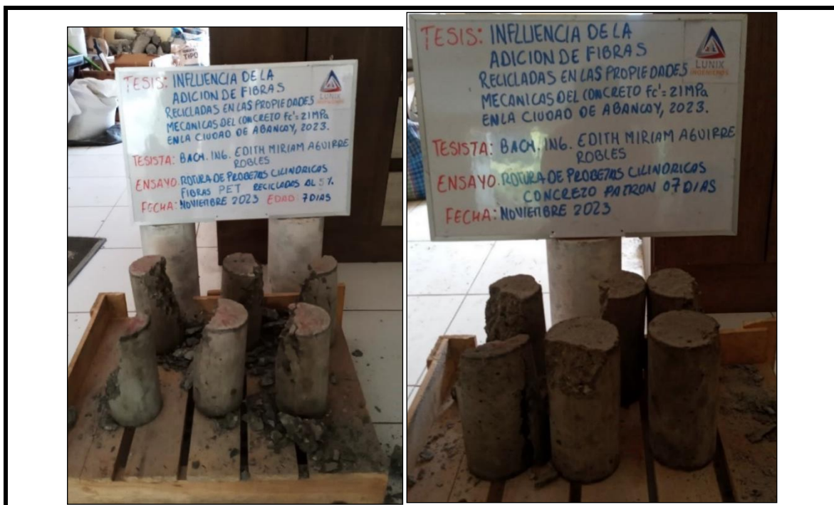
Figura 61 — Especímenes cilíndricos de concreto después de ser sometidos al ensayo de compresión simple
