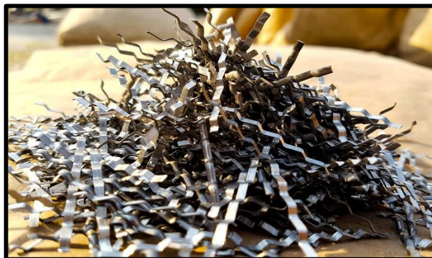
Figura 4 — Fibras de acero para concreto
