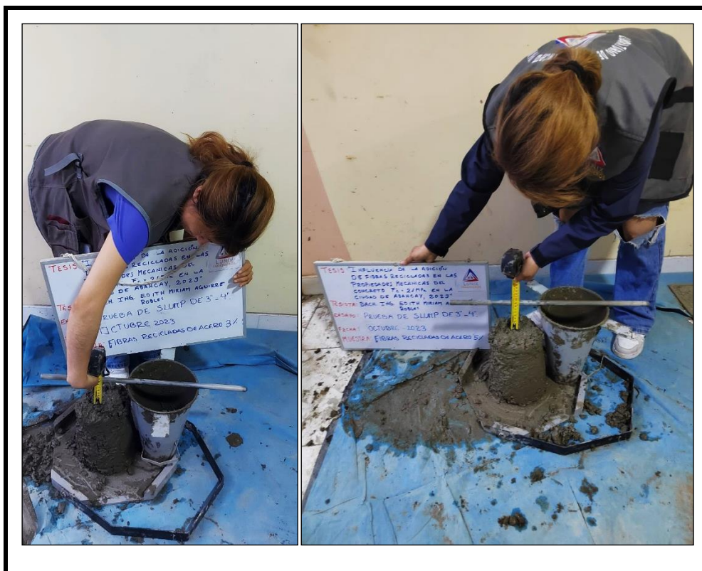
Figura 54 — Medición del asentamiento del concreto fresco
