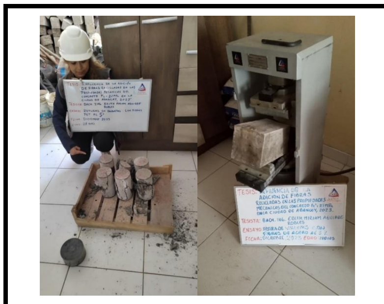
Figura 12 — Ensayo de resistencia a la compresión simple y resistencia a la flexión
