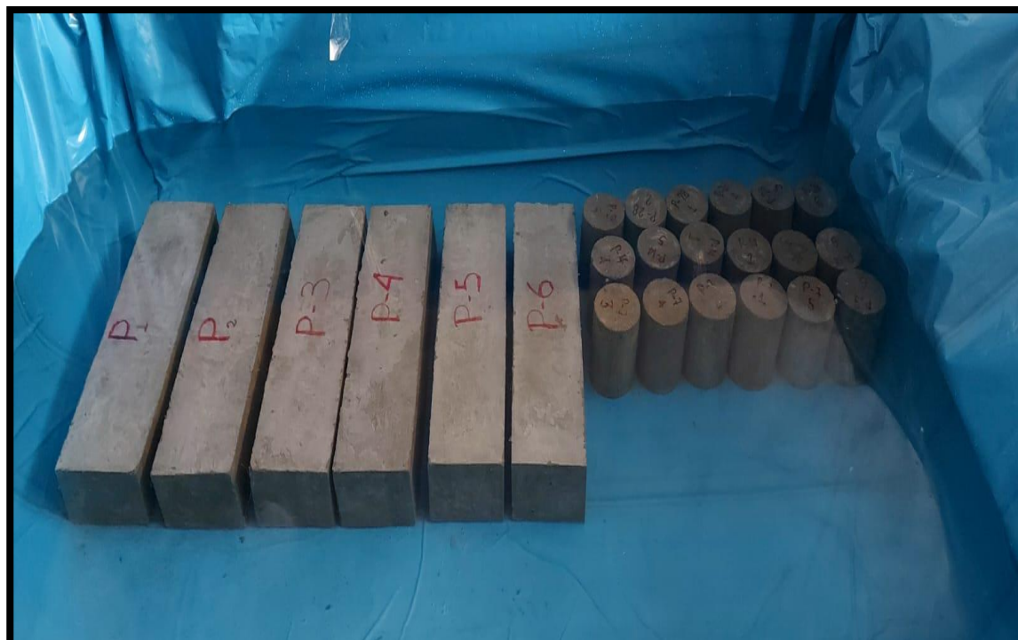
Figura 57 — Proceso de curado del concreto
