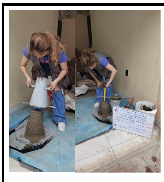
Figura 8 — Medición del asentamiento del concreto
