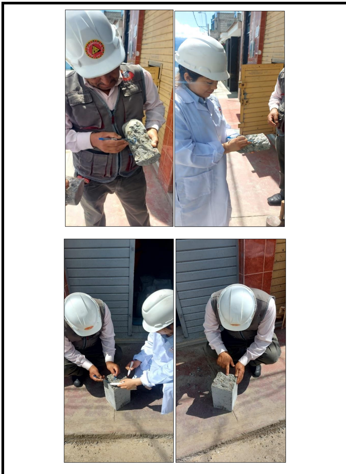
Figura 66 — Análisis visual de la estructura del concreto con presencia de fibras PET y fibras de acero
