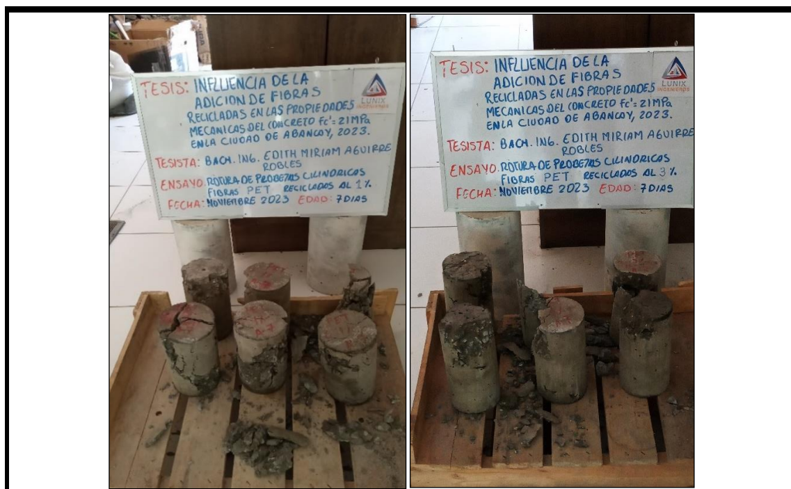
Figura 60 — Especímenes cilíndricos de concreto después de ser sometidos al ensayo de compresión simple
