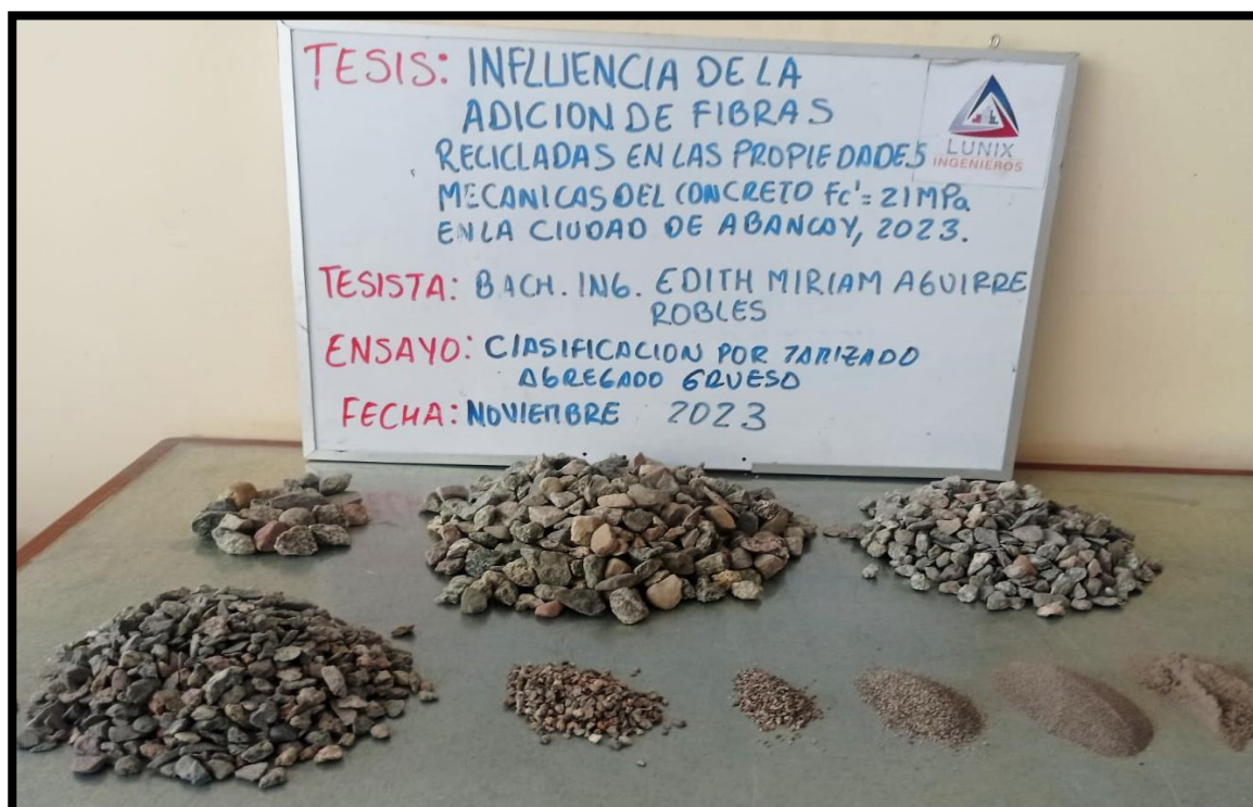
Figura 50 — Análisis granulométrico del agregado grueso
