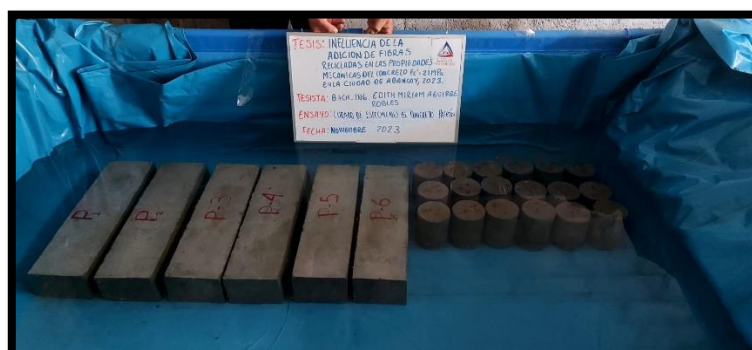
Figura 11 — Curado del concreto
