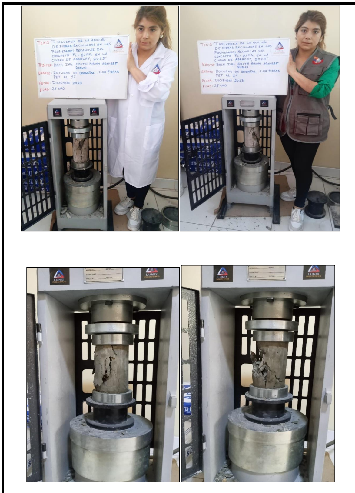
Figura 64 — Ensayo de resistencia a la compresión de probetas de concreto a edades de 7, 14 y 28 días
