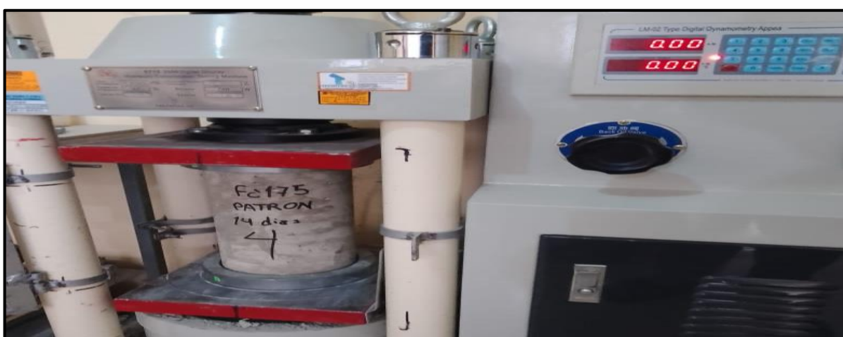
Figura 57 — Ensayo a compresión de los testigos cilíndricos con incorporación de AGR-C a 14 días
