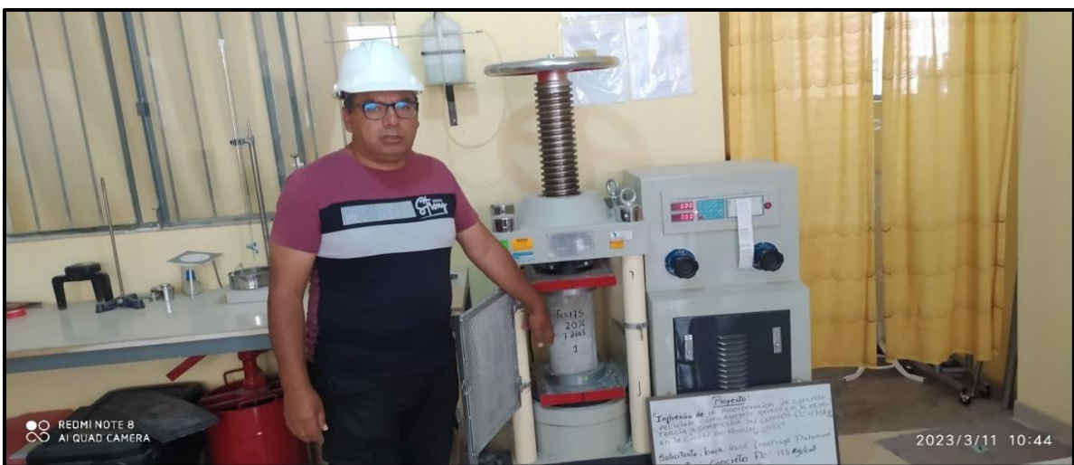
Figura 54 — Ensayo a compresión de los testigos cilíndricos con incorporación de AGR-C a 7 días
