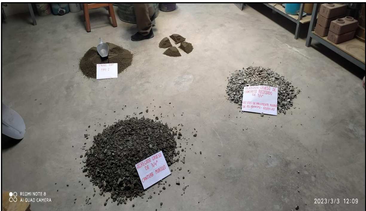
Figura 48 — cuarteo de materiales para realizar estudio granulométrico
