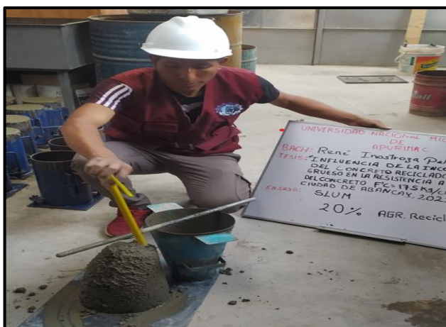
Figura 27 — Control del asentamiento del concreto fresco
