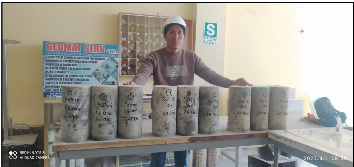
Figura 59 — Testigos para las respectivas roturas a compresión con AGR-C a 28 días
