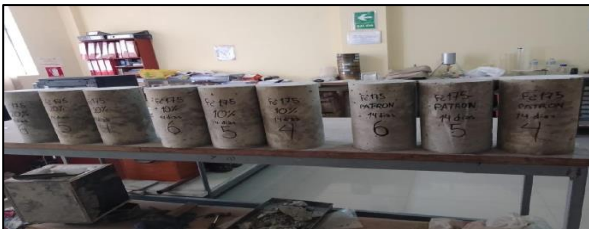
Figura 56 — Testigos para las respectivas roturas a compresión con AGR-C a 14 días
