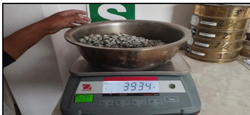
Figura 20 — Tamizado del agregado luego del ensayo de abrasión
