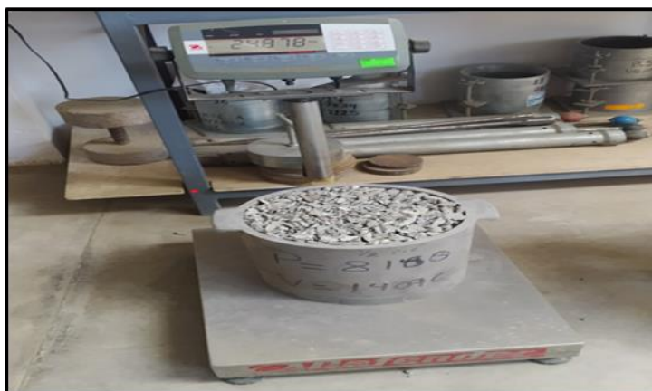
Figura 15 — Ensayo de peso unitario suelto del agregado reciclado
