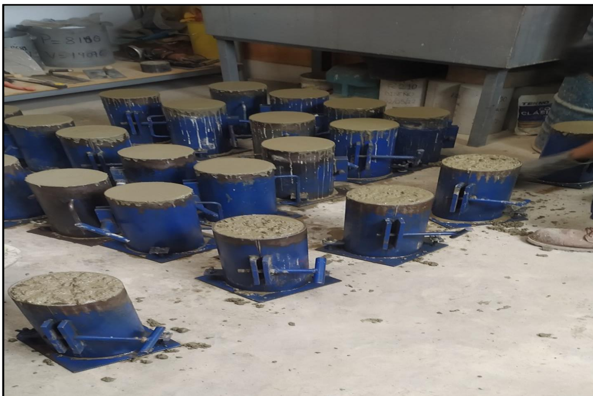
Figura 51 — elaboración de testigos cilíndricos
