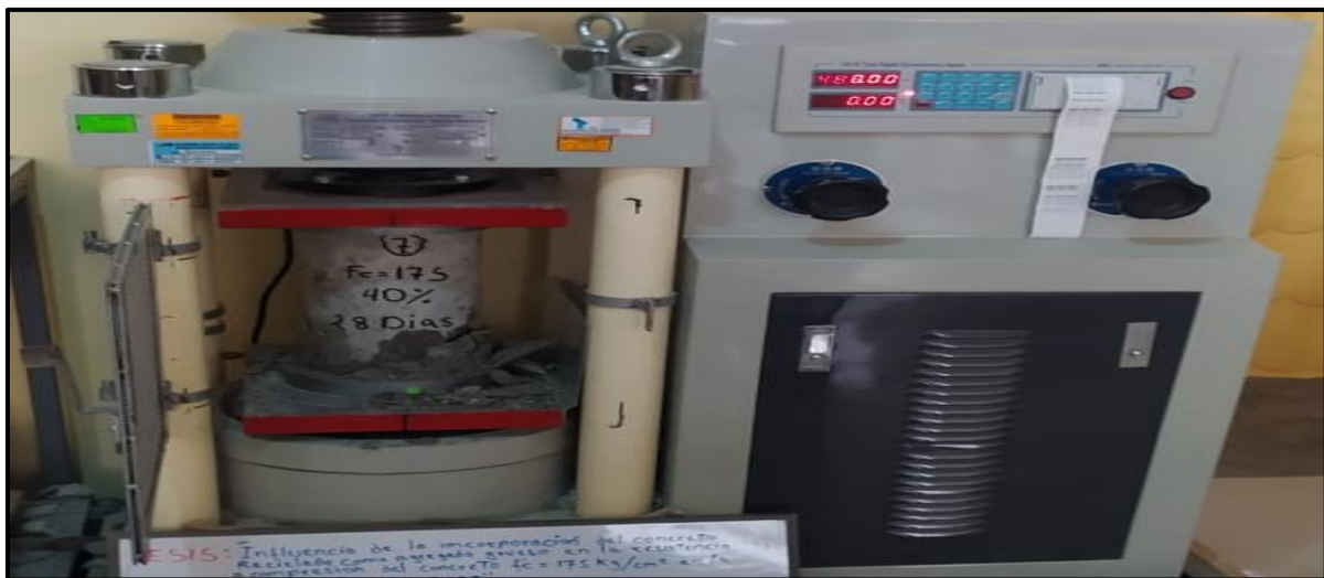
Figura 59 — Ensayo a compresión de los testigos cilíndricos con AGR-C a 28 días
