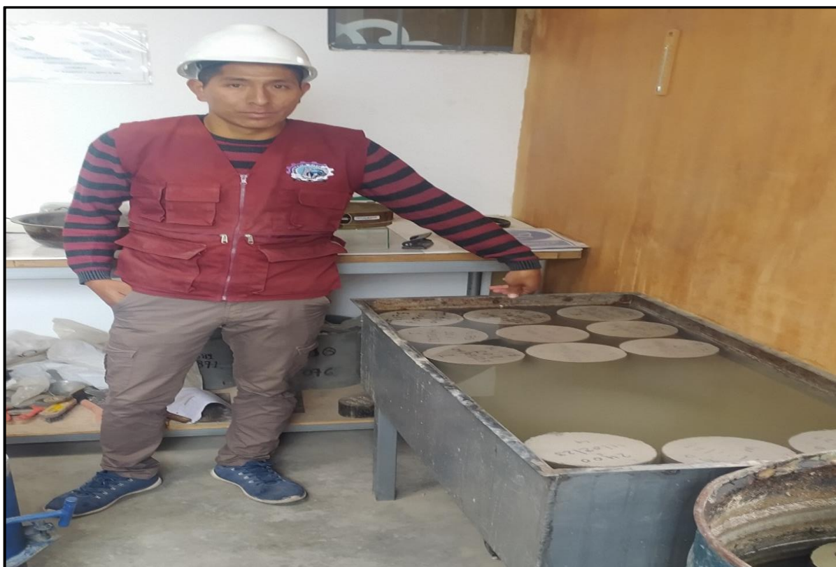
Figura 52 — curado de los testigos
