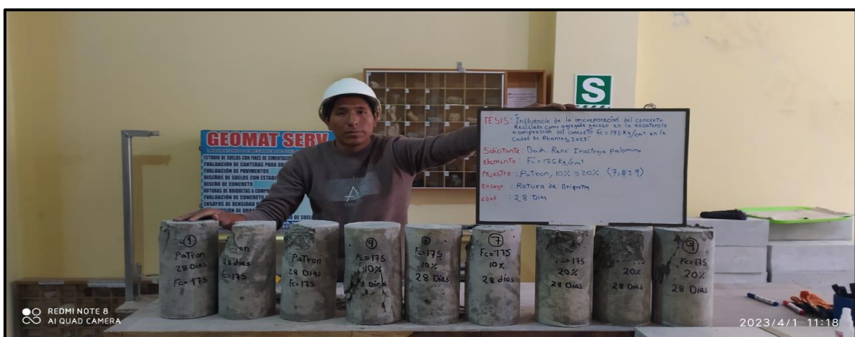
Figura 60 — daños físicos de las briquetas después de la compresión a los 28 día
