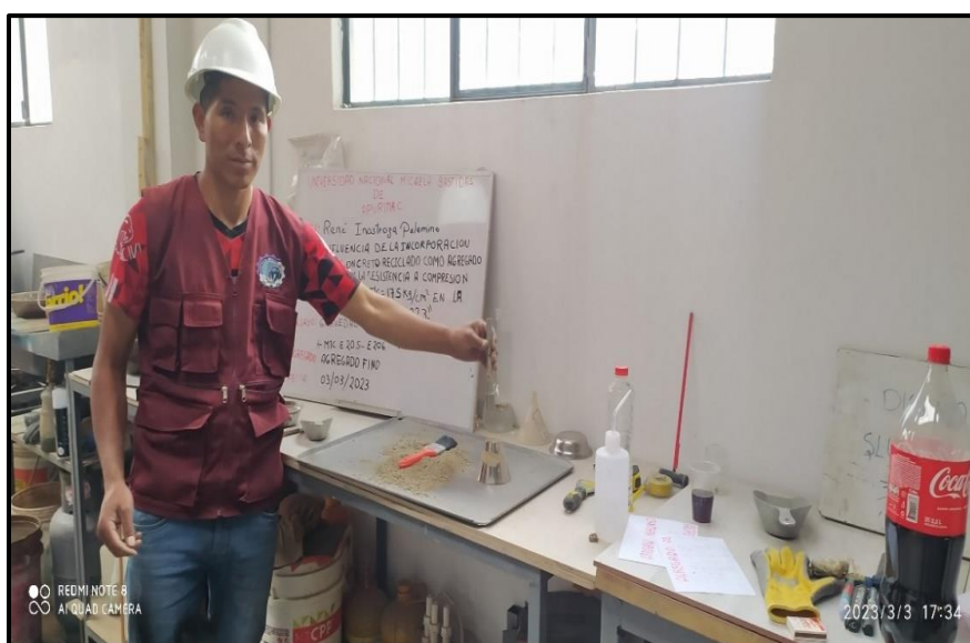
Figura 16 — Ensayo de gravedad específica y absorción del agregado fino
