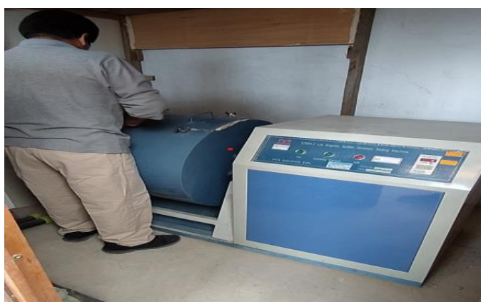
Figura 19 — Ensayo de abrasión de los ángeles
