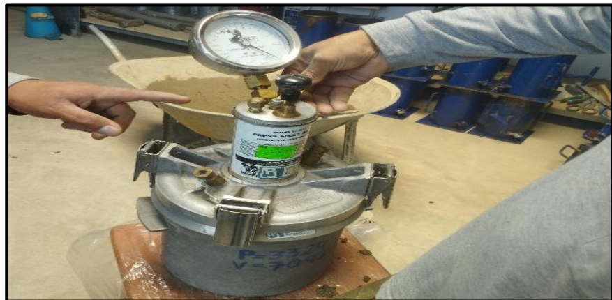
Figura 29 — Ensayo del aire atrapado en el concreto fresco
