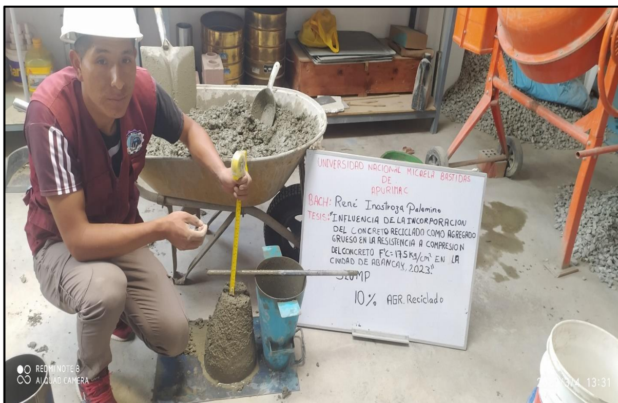
Figura 50 — Ensayo de slump en estado fresco
