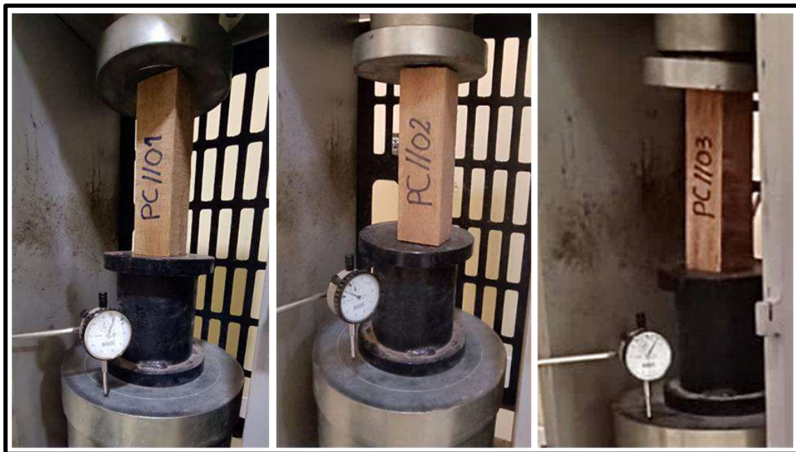
Figura 167 — Ensayo para determinar la resistencia a compresión paralela
