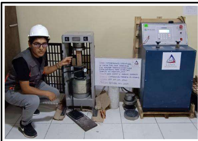
Figura 163 — Ejecución de ensayo de compresión paralela
