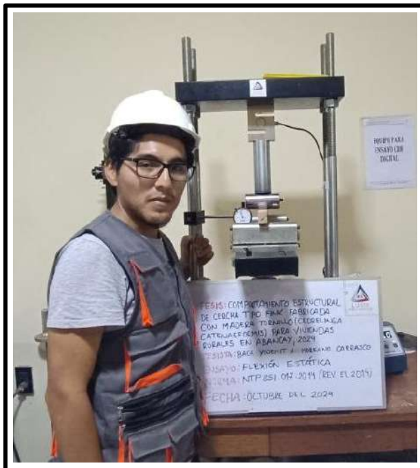
Figura 173 — Ejecución de ensayo de flexión estática
