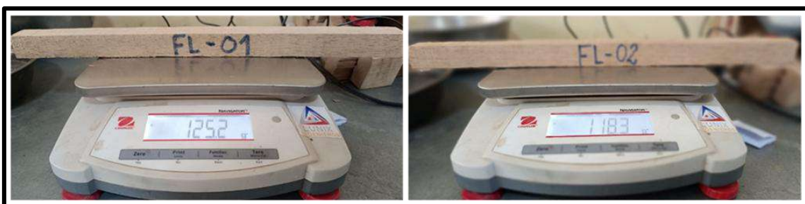
Figura 176 — Pesaje de probetas previas al ensayo de flexión
