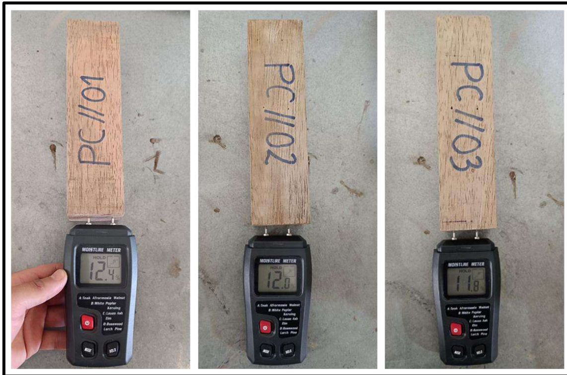
Figura 164 — Contenido de humedad previas al ensayo de compresión paralela
