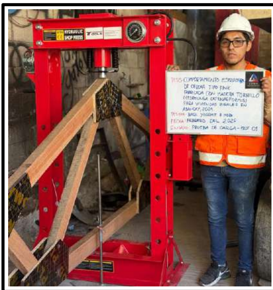
Figura 182 — Prueba de carga del prototipo 01
