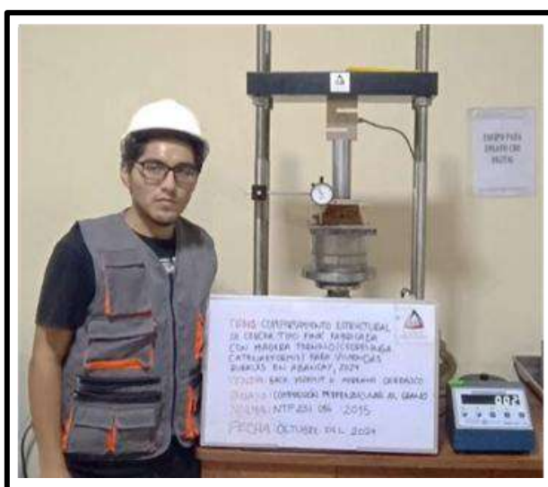
Figura 168 — Ejecución de ensayo de compresión perpendicular
