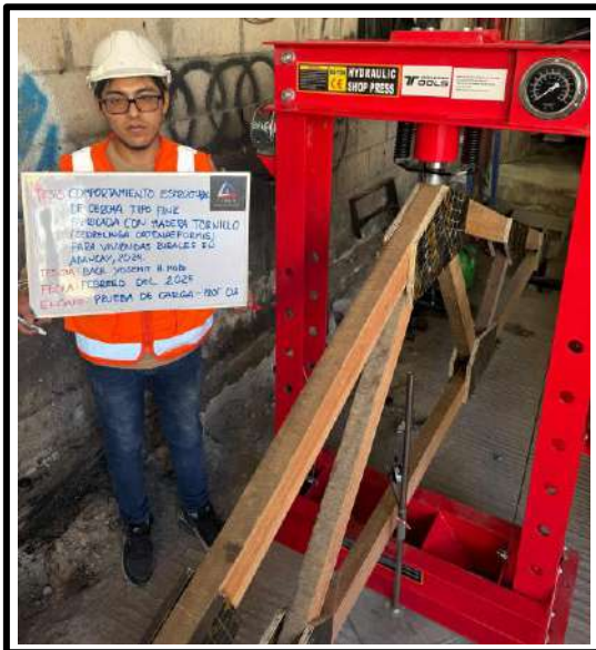
Figura 183 — Prueba de carga del prototipo 02
