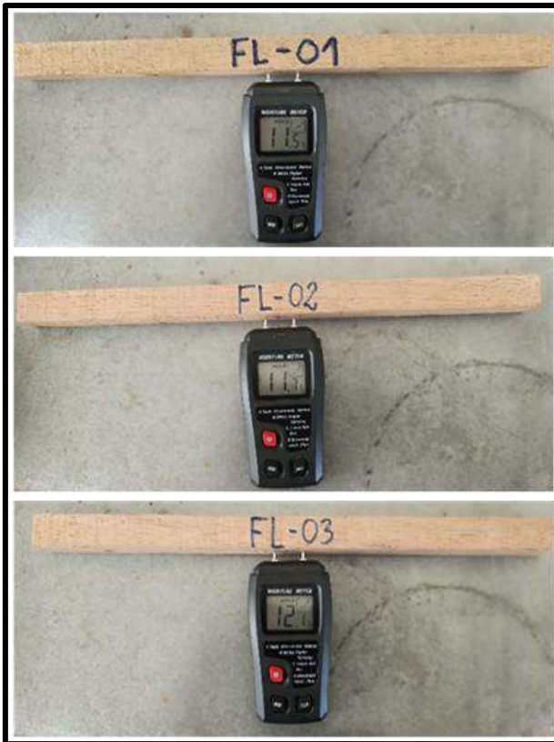
Figura 174 — Medición del contenido de humedad previas al ensayo de flexión
