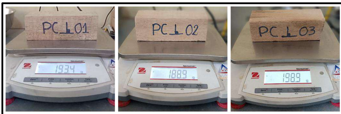
Figura 171 — Pesaje de probetas previas al ensayo de compresión perpendicular
