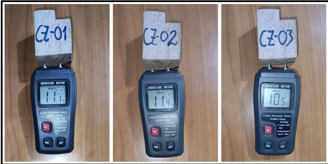
Figura 161 — Medición del contenido de humedad previas al ensayo de cizallamiento
