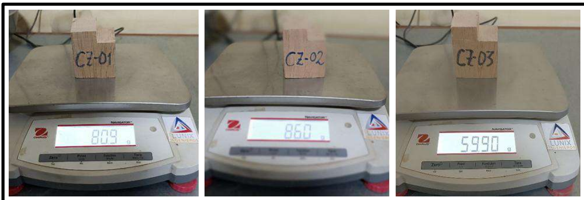
Figura 162 — Pesaje de probetas previas al ensayo de cizallamiento paralelo
