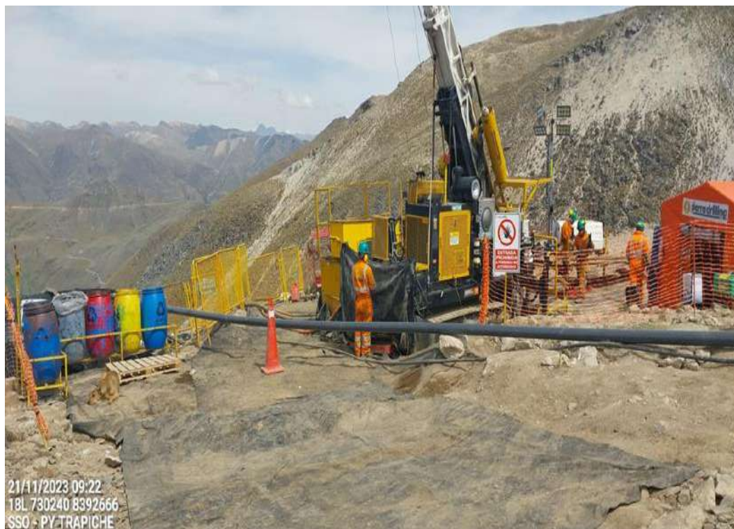
Figura 67 — Perforación diamantina realizado por Sierra Drilling
